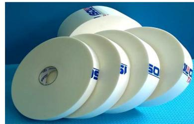
Лента уплотнительная для монтажа гипсокартонных конструкций с односторонним клеевым акриловым слоем, без антиадгезионной защиты клеевого слоя. Это является главной отличительной чертой материалов этого типа. Адгезия, или клейкость дихтунгсбанд сбалансирована так, что ленты отлично монтируются на металлоконструкции, но в рулоне ни один слой клейкой ленты не прилипает «намертво» к другому. ДХБ изготавливается из Изолон ППЭ (Isolon 500)
