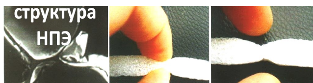
Структура Isolon 100 при нагрузках не восстанавливается.
