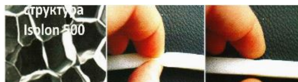
Структура Isolon 500 и Isolon 300 при нагрузках восстанавливается.
