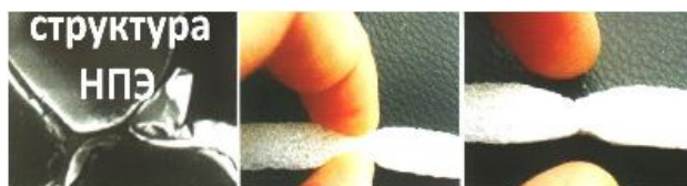
Структура Isolon 100 при нагрузках при нагрузках не восстанавливается.
